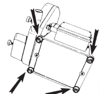
Все модели укомплектованы 4 опорными стойками, изготовленными из резины, что обеспечивает уменьшение вибрации и понижение уровня шума.
